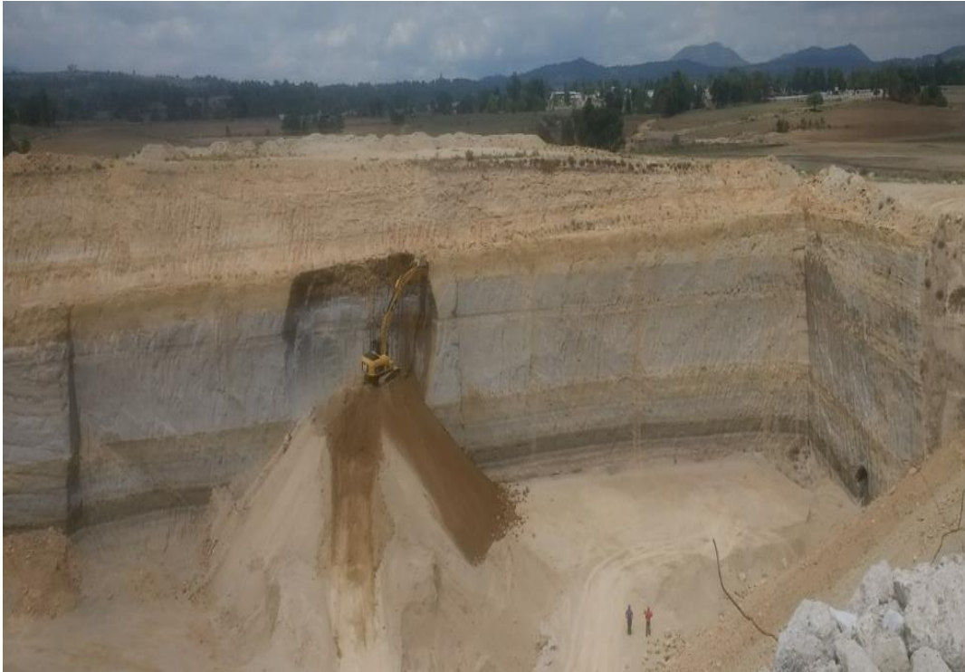
Figura 4. Perfil de excavación minera, se observan las capas debajo del manto superior
