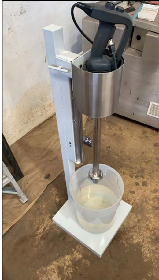
Figura 2. Prototipo de batidora semi industrial para elaboración de gel antibacterial.
