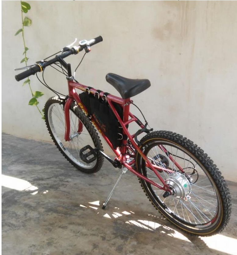
Imagen 4. Bicicleta reconstruida rodada 24 con motor eléctrico (modelo para la medición longitudinal del rendimiento).
