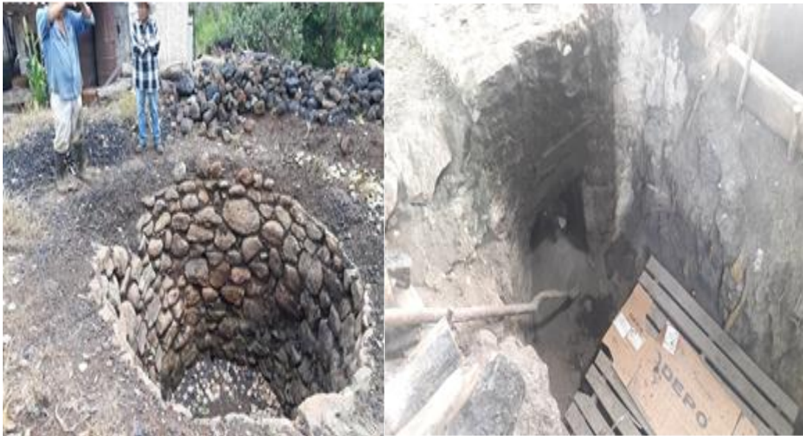
Figura 2 y 3. Horno para quema de piña y horno que alberga la leña para el destilado.
